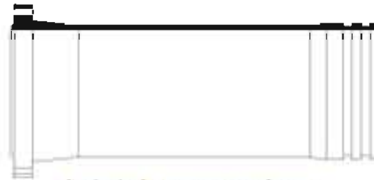
ข้อต่อท่อสั้นแหวนยาง-หน้างาน Spigot- Flanged Coupling
