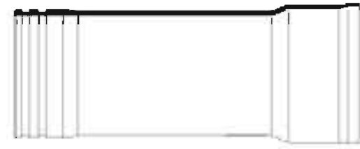
ข้อต่อท่อสั้นปากกระบัง - แหวนยาง Bell-Spigot Coupling
