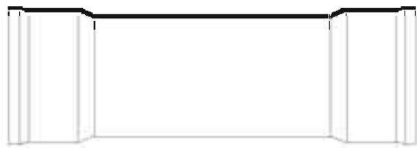
ข้อต่อท่อสั้นปากกระบัง 2 ด้าน Both ends Belled Coupling
