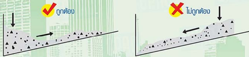
วิธีการเทคอนกรีตบริเวณพื้นที่ลาด
