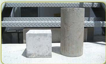
แท่งตัวอย่างสำหรับทดสอบค่ากำลังอัดแบบทรงลูกบาศก์และทรงกระบอก
