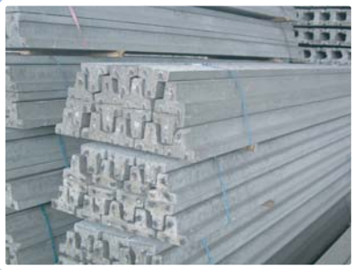
เสาเข็มคานที่ ความยาว 1.00 - 4.00 เมตร ลวด PC-WIRE ขนาด 4 ม.ม. จำนวน 5 เส้น
