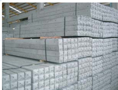
เสาหัวคองกรีตอัดแรง ขนาด 3 นิ้ว และ 4 นิ้ว ความยาว 1.00-4.00 เมตร ลวด PC-WIRE ขนาด 4 ม.ม. จำนวน 4 เส้น
