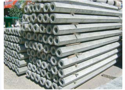
เสาเข็มทกเหลี่ยมกลวง ความยาว 1.00-6.00 เมตร ลวด PC-WIRE ขนาด 4 ม.ม. จำนวน 4 เส้น พร้อมปลอกเสา
