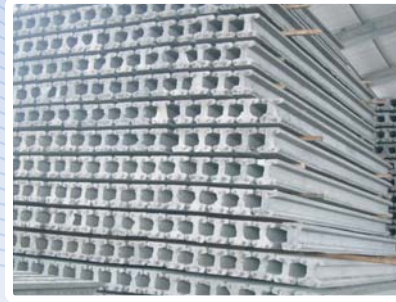
เสาเข็มไอ 15 ความยาว 2.00-6.00 เมตร ลวด PC-WIRE ขนาด 4 ม.ม. จำนวน 4 เส้น พร้อมปลอกเสา
