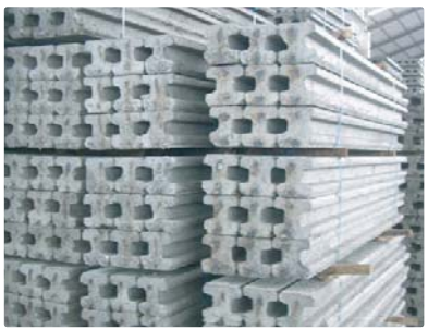
เสาเข็มไอ 12 ความยาว 1.00-4.00 เมตร ลวด PC-WIRE ขนาด 4 ม.ม. จำนวน 2-3 เส้น
